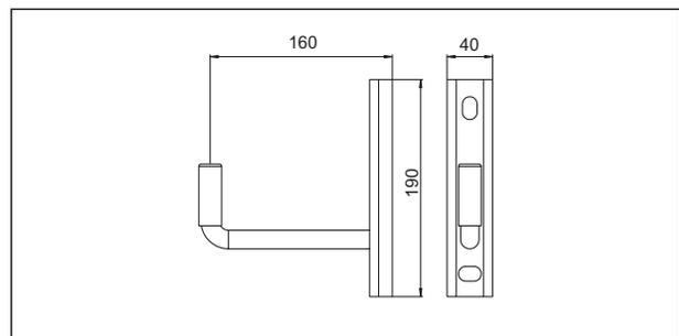
Dimensioni supporto di fissaggio a muro
